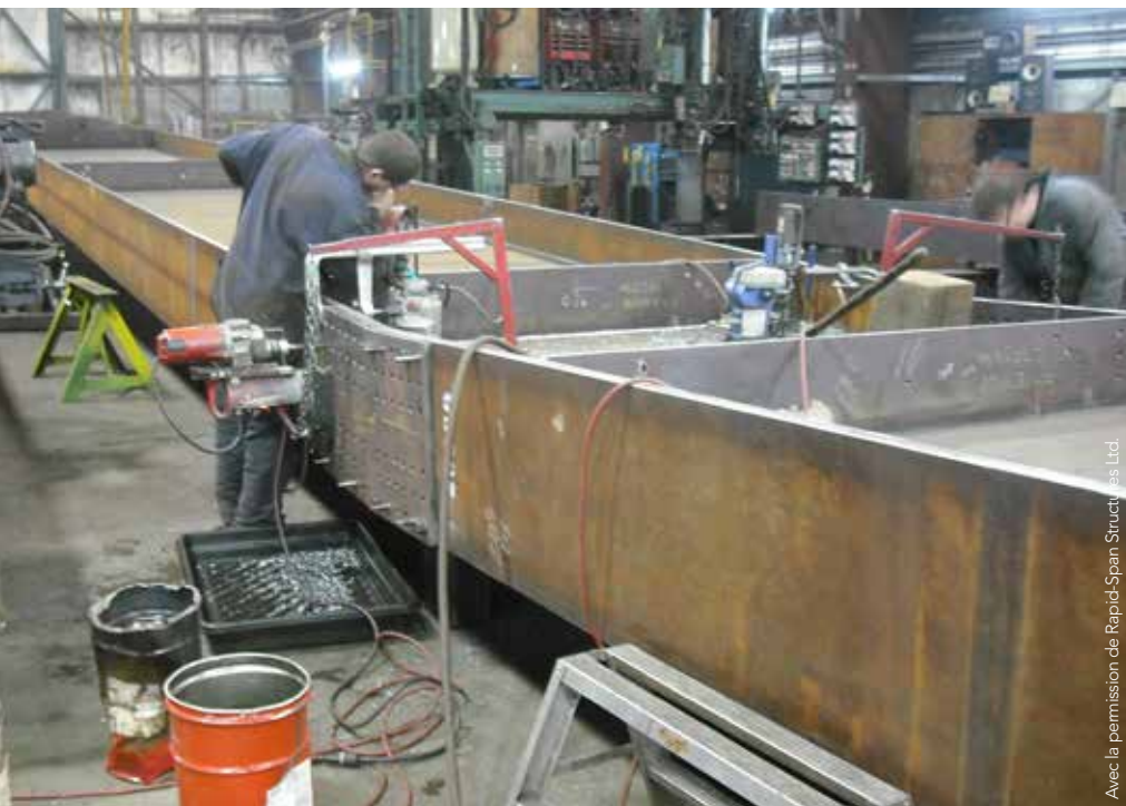
FIGURE 2 : Fabrication des poutres du pont 23.5
